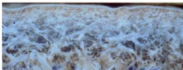
图1 天然头层皮革横截面高倍显微镜图
